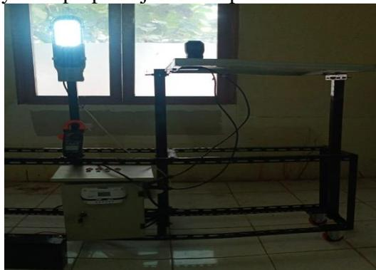
Gambar 1. Rangkaian panel dengan Lampu PJU
